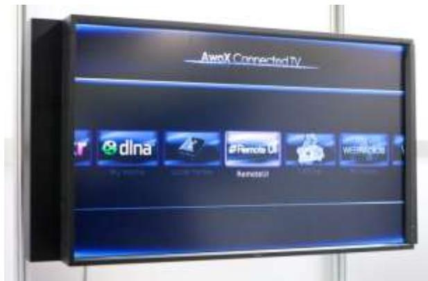
Ils travaillent aussi sur le déport d'interface utilisateur sur TV connectée (en mode « client léger ») avec la norme CE 2014A qui est un dérivé d'HTML et supportera l'audio et la vidéo en 2011.
