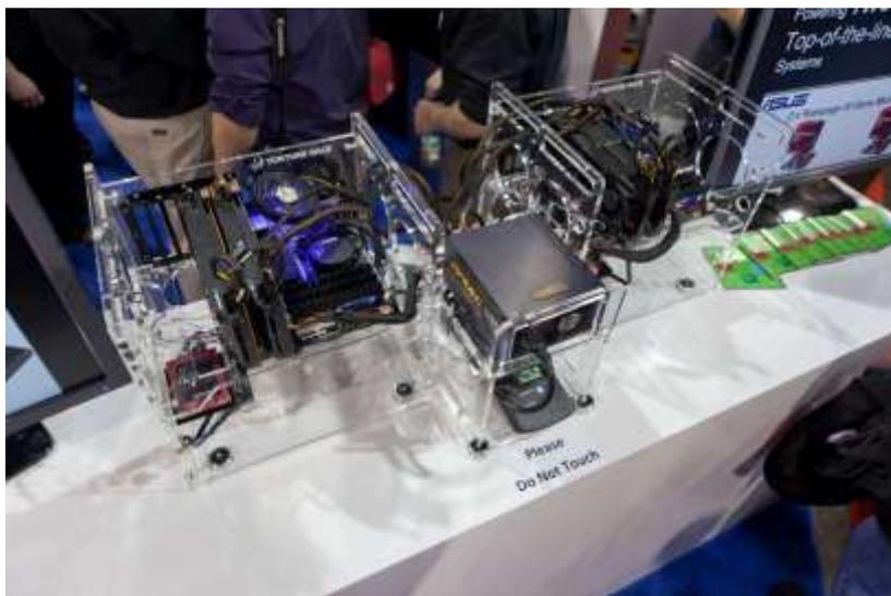
Et puis ce système de **refroidissement** utilisant un liquide caloporteur blanc composé de nanoparticules de zinc qui conduit mieux la chaleur que l'eau. Utile pour les rois de l'overclocking et autres gamers. Après, il y a le sodium liquide des surgénérateurs, mais c'est trop dangereux...
