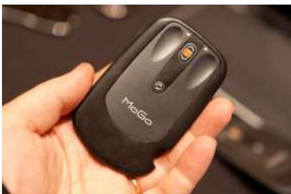
Souris **MoGo** TM1 optique et toute plate pour laptop (7 mm d'épaisseur), en liaison sans fil Bluetooth. Sa batterie ne dure que 8 heures et elle se recharge via un câble USB.
