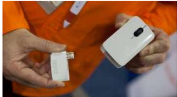
La **Digitz** EZMouse est une souris sans fil avec un dongle contenant une batterie qui se recharge en USB. Et la souris peut fonctionner plusieurs jours sans ce dongle grâce à une mini batterie intégrée.
