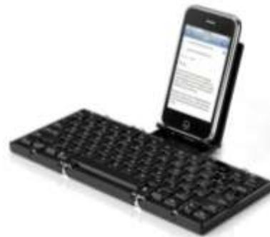
Le clavier **Jorno** est quant à lui de grande taille et en plus pliable. Il se connecte à l'iPhone en Bluetooth et sa batterie rechargeable est censée durer un mois.
